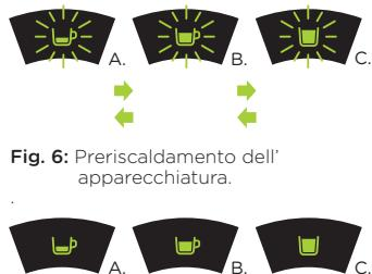
**Fig. 6:** Preriscaldamento dell'apparecchiatura.
